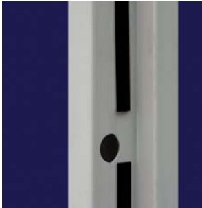
Junta intumescente: Junta de grafito que dilata hasta 25 veces su tamaño original a partir de una temperatura superior a 150°.
